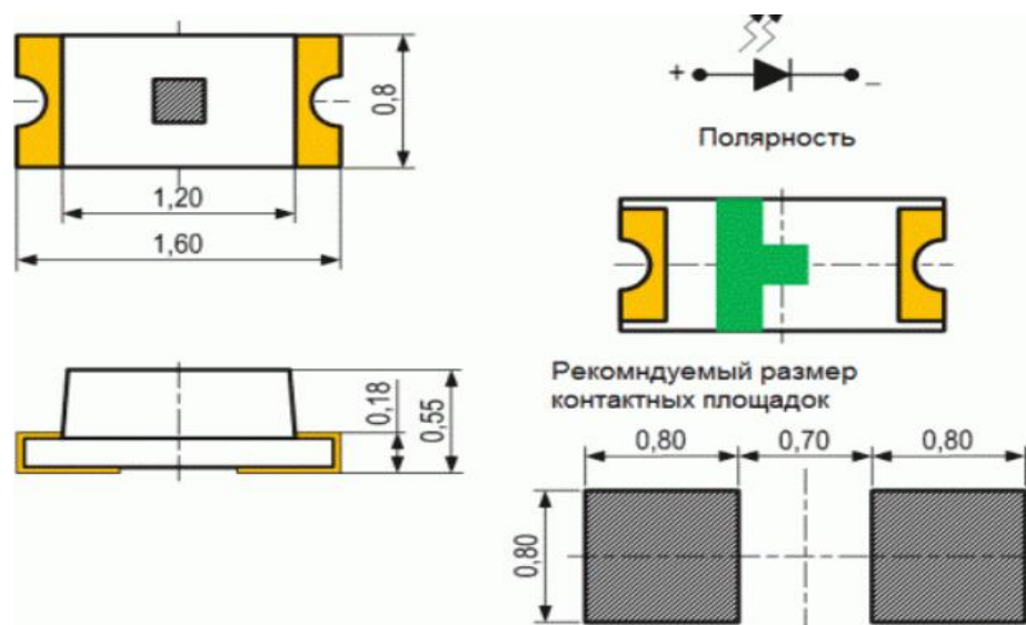
2.14-сурет - SMD 0603 жарықдиодының схемасы
