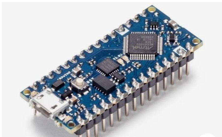
2.18-сурет - Arduino nano өмірдегі кестесі
